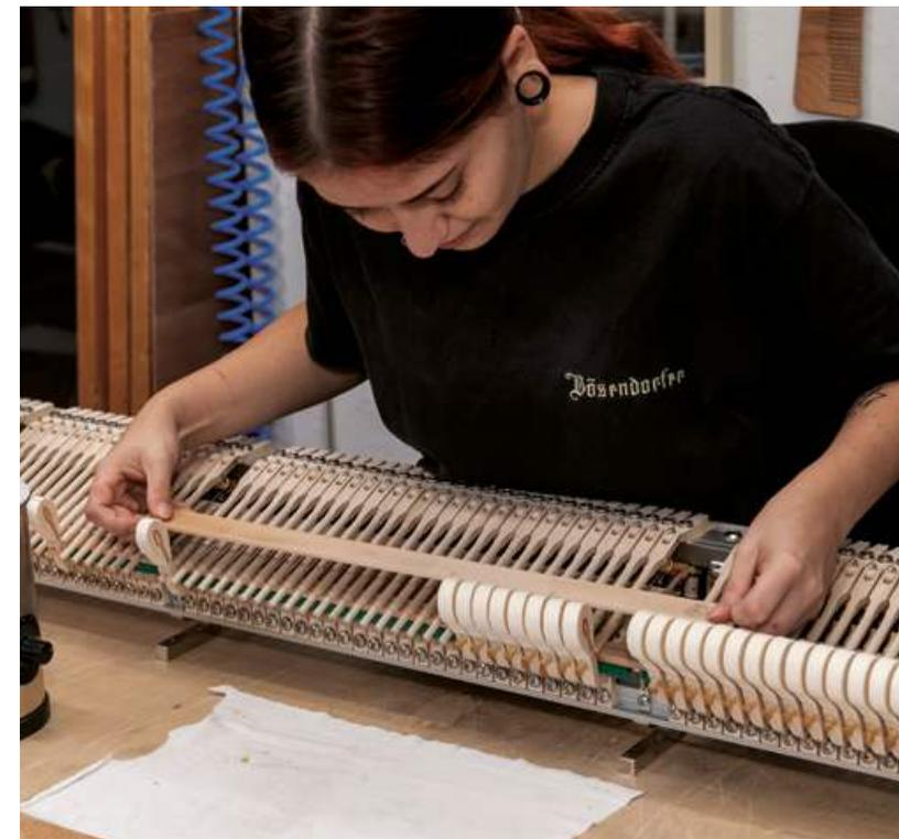
**Links:** Michelle Krammer leimt die gebohrten Hammerköpfe auf die Hammerstiele. Dazu gehört auch die kontinuierliche Kontrolle der korrekten Ausrichtung der Köpfe bevor der Leim aushärtet. Um die 5.000 Teile der Mechanik kommen hier zusammen und werden sorgfältig aufeinander abgestimmt. Sie alle haben eine enorme Bedeutung und beeinflussen die Spielart und Klanggestaltung der Instrumente.
