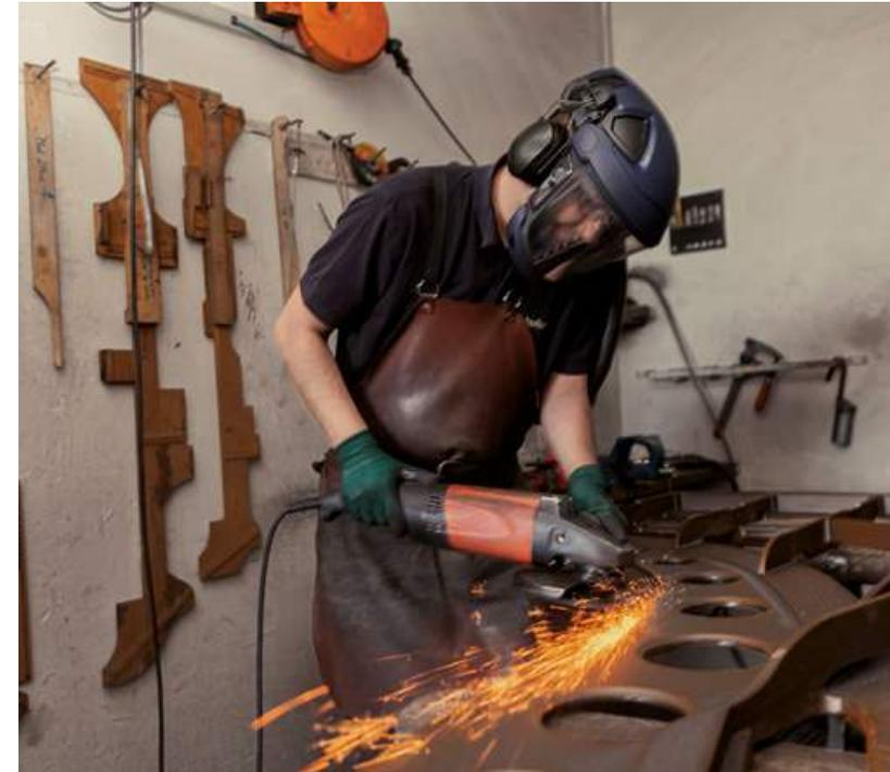
**Links** zischen glühend heiße Funken durch die Luft wenn Mario Höller den Gussrahmen eines Flügels für die weitere Veredelung vorbereitet. Der Gussrahmen trägt später die gewaltigen Zugkräfte der gespannten Saiten – bei einem Konzertflügel sind es nahezu 20 Tonnen.
