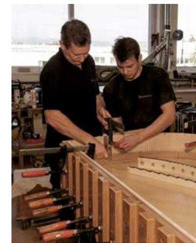
**Links** befestigen Philipp Smejkal und Moritz Ewald mit Schraubzwingen die Verleimschablonen. Sie verteilen den Druck gleichmäßig auf die dahinter liegenden Kastenwände und stellen sicher, dass der Leim Kastenwand und Korpus fest mit einander verbindet.
