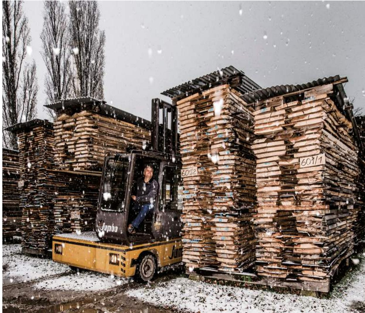
**Oben:** Bis zu 5 Jahre trocknet das Holz im Freien. So bereiten wir den kostbaren Rohstoff schonend auf die Produktion vor und erhalten seine klanglichen Eigenschaften. Ist die Trocknung im Freien abgeschlossen wird das Holz zugeschnitten und im klimatisierten Trockenraum gelagert.
